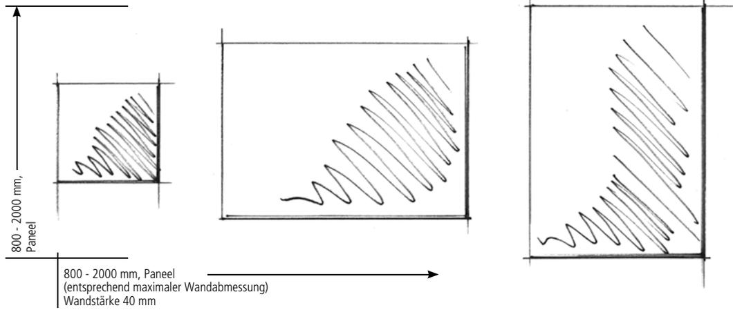
**Wand- und Deckenabsorber** Ausführung akustisch, mit Gipschaum-Füllung
