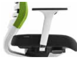
Armlehnen/Armrests Nr. 597 5F, höhenverstellbar (10 cm), 2fach werkzeuglos breitenverstellbar (6 cm je Seite) und tiefenverstellbar (4 cm) sowie radial um 30° schwenkbar. Armauflagen PU soft (schwarz), Hülse schwarz oder weiß, Armlehnen-träger Aluminium poliert.
