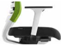
Armlehnen/Armrests Nr. 525 3F, höhenverstellbar (10 cm), werkzeuglos breitenverstellbar (3,5 cm je Seite) und tiefenverstellbar (4 cm). Armauflagen PU soft (schwarz), Armlehnen-träger Kunststoff schwarz, Hülse schwarz oder weiß.
